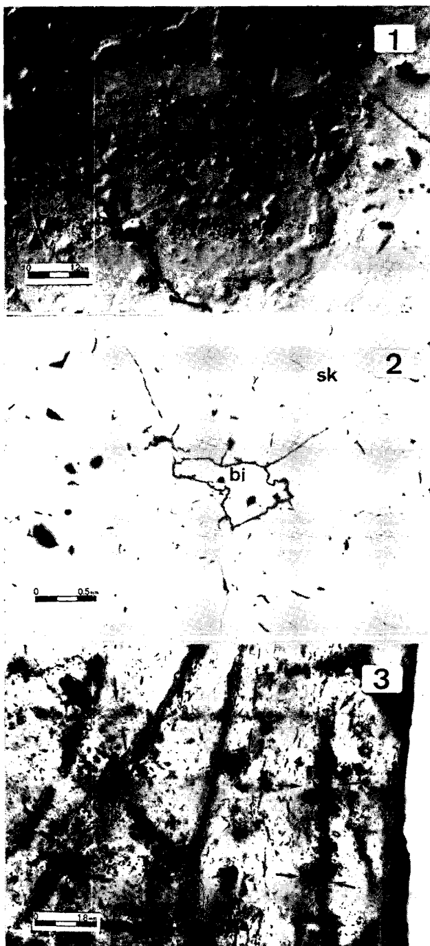
Figura 5.- 1. Bismuto nativo en forma de grupos de gotas dispersas en skutterudita. bi, bismuto nativo; nq, niquelina; sk, skutterudita. Muestra 209K.
