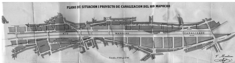
Figura 3. Plano del segundo y definitivo proyecto de canalización del río Mapocho.
