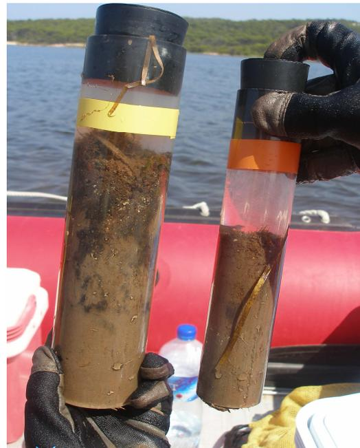
Foto de los cilindros usados en los experimentos de sedimentación
