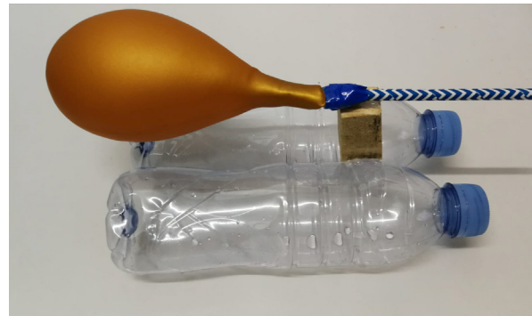
Figura 2. Barco propulsado por un globo. Fuente: Propia.
