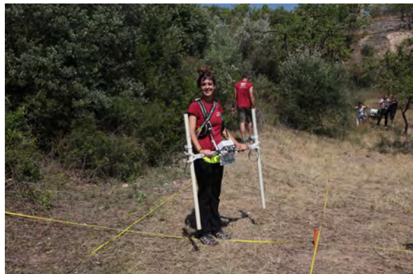
Figura 5: Gradiòmetre. SOT. Prospecció arqueològica (Font DIDPATRI).
