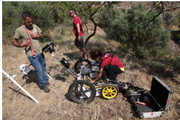
Figura 4: Radar de l'empresa SOT. Prospecció arqueològica (Font DIDPATRI).
