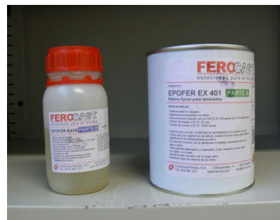
Figura 20. Resina epoxídica utilizada en el vaciado definitivo: EPOFER EX401, con su endurecedor E416. Fuente: original de la autora.
