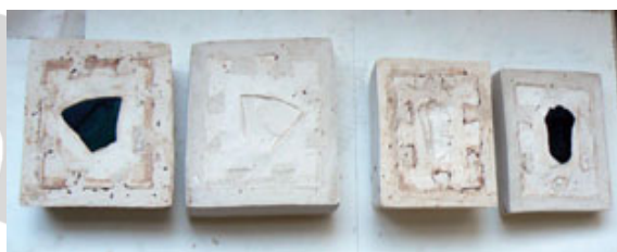
Figura 19. Apertura de los moldes. Aún conservan en su interior las piezas de resina Visi-jet® FTX . Fuente: original de la autora.
