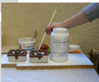
Figura 14. Aplicación de vaselina alrededor de la pieza, sobre la silicona de la primera parte del molde. Fuente: original de la autora.
