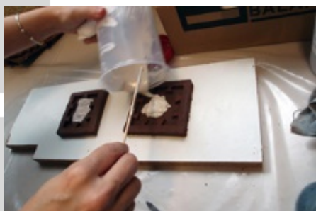
Figura 10. Aplicación de la primera capa de silicona líquida mezclada con su agente de curado (sin agente tixotrópico). Esta es la capa de registro. Fuente: original de la autora.
