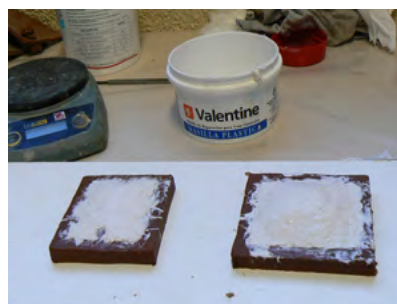
Figura 11. Aplicación de la capa de silicona con agente tixotrópico sobre la anterior ya curada. Después, se aplacan las crestas de la silicona. Fuente: María Ávila Rodríguez.
