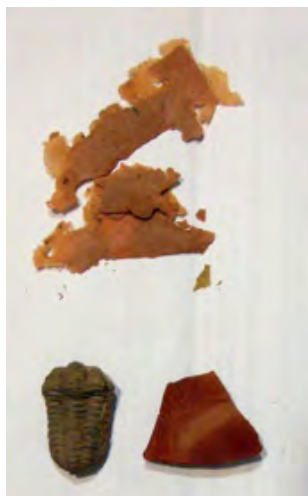
Figura 27. Vaciados de resina una vez eliminada la rebaba. Fuente: original de la autora.
