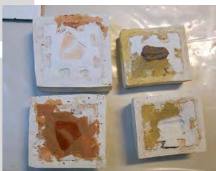
Figura 25. Apertura de los moldes. Puede observarse la rebaba de resina alrededor de los vaciados. Fuente: original de la autora.
