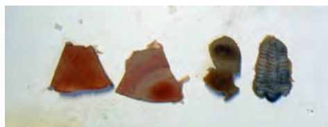
Figura 24. Después de aplicada la resina del color de base y transcurrido su tiempo de curado (24h), se retiran las pequeñas pruebas y se observa si ha funcionado bien el pigmento en polvo aplicado y su color de base en cuanto al color obtenido. Fuente: original de la autora.
