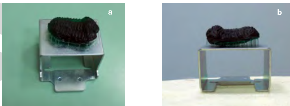
Figura 6. Pletina, una vez extraída de la impresora con la impresión en resina del Trilobite . Aún presenta soportes. a) Vista superior. b) Vista lateral. Fuente: original de la autora.
