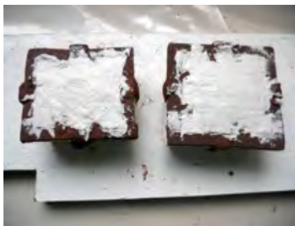
Figura 16. Crestas de silicona ya aplacada. Fuente: María Ávila Rodríguez.
