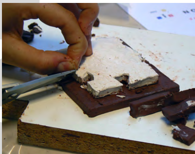
Figura 12. Se perfilan las colas de milano de silicona, una vez eliminado el encofrado de plastelina. Fuente: María Ávila Rodríguez.
