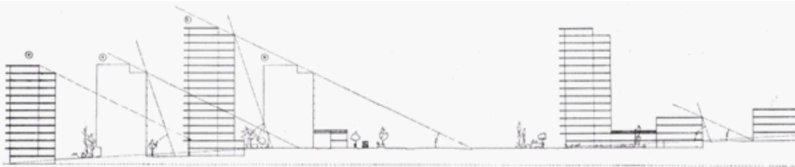
Fig. 06 Sección transversal del Proyecto de Urbanización de la Diagonal de Barcelona, se muestra la relación de distancia entre bloques de acuerdo al asoleamiento.
