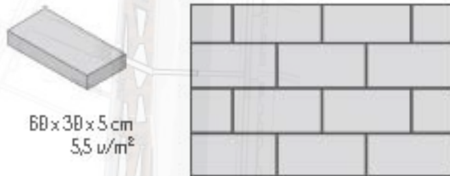
Modelo ISHI, de la casa Breinca. Baldosas de 60x30x5 cm. con junta gris de 5mm.
