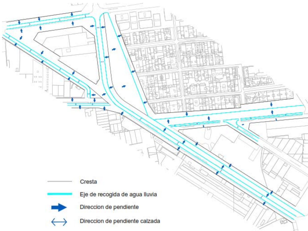
Imagen 39. Esquema general de los drenajes
